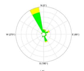
(d) Fig. 4. Wind rose diagram for horizontal directionality of ambient noise (a) 200 Hz (b) 400 Hz (c) 500 Hz (d) 800 Hz
